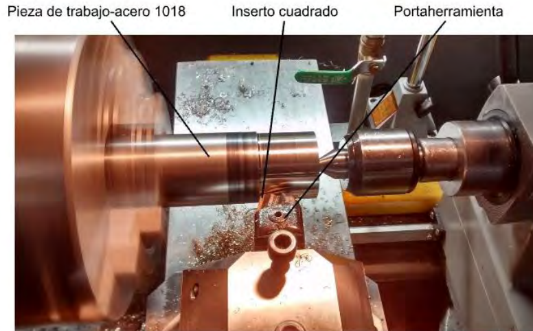
Figura 3.10.- Experimento de prueba para el maquinado en acero 1018.
