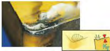
Figura 2.8. Cráter de desgaste en inserto. Adaptado de Sandvik Coromant.
