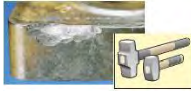
Figura 2.9 Desgaste por despostillamiento. Adaptado de Sandvik Coromant. ( Manual Sandvik Coromant, 2016 ).
