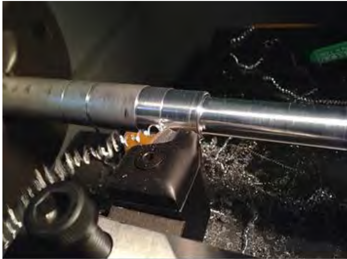
Figura 3.13.-Prueba experimental de maquinado en aluminio 6061 T6.
