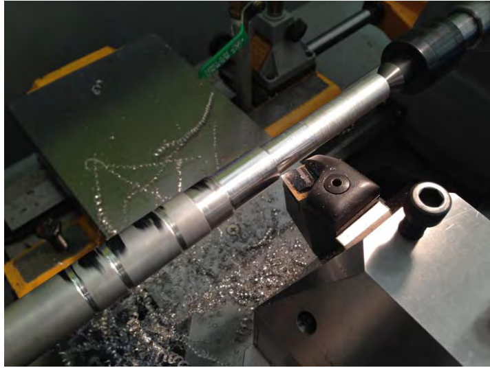
Figura 3.12.- Prueba de medición de la fuerza de corte en aluminio 6061 T6.
