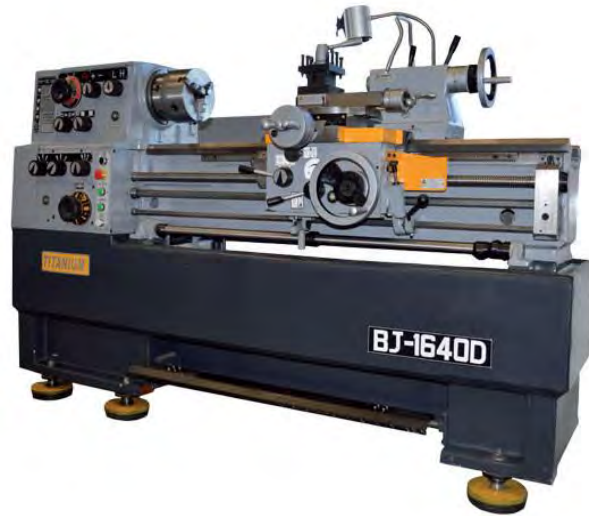
Figura 3.1.- Torno Titanium BJ1640D, utilizado en la medición de fuerza de corte.
