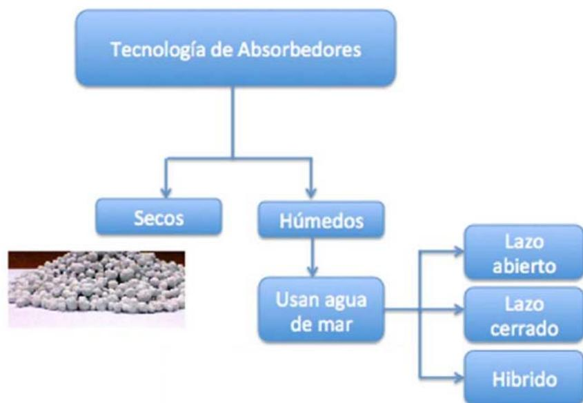
Figura 2.3 1 Esquema de clasificación de lavadores en barcos. (Hombravella et al., 2011)
