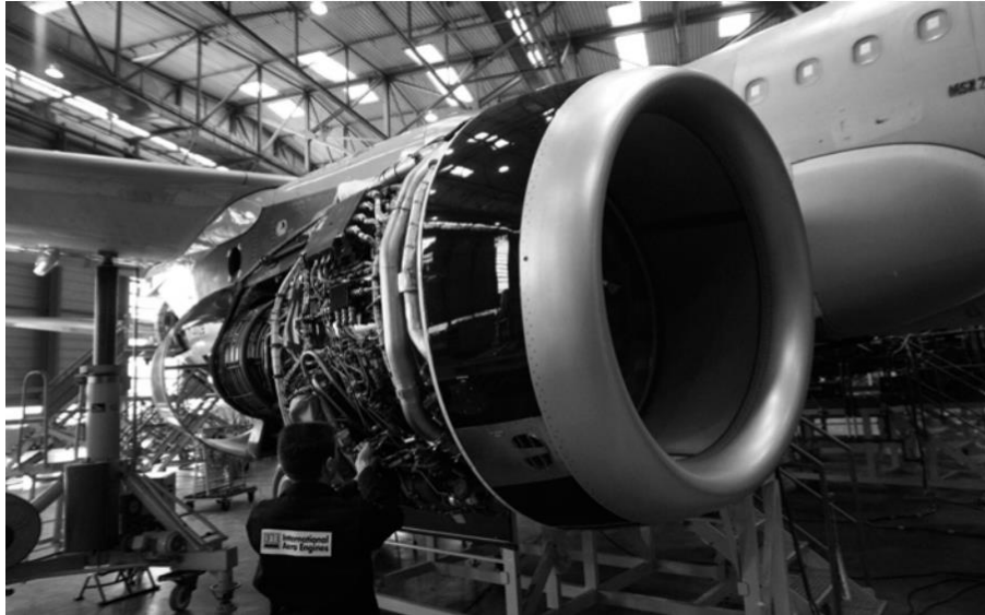
Figura 1.4 Un sistema de producción aeronáutica. Ejemplo de un sistema tipo Fixed-Position Shop Fuente [1].
