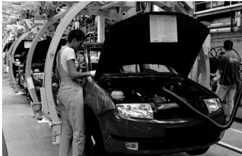
Figura 1.2 Línea de ensamblaje automotriz ejemplo práctico de un sistema tipo Flow Shop. Fuente [1].
