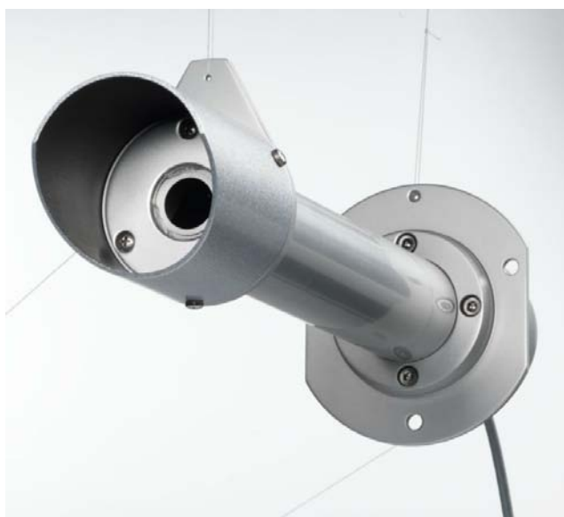
Figura 1.15: Pirheliómetro de tubo.
