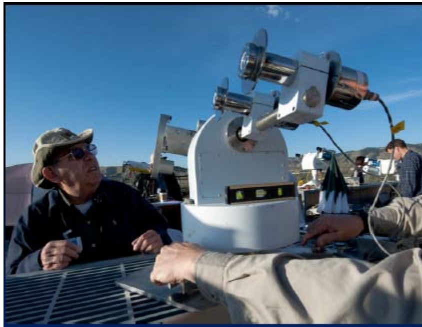
Figura 1.17: Montaje ecuatorial de un pirheliómetro.
