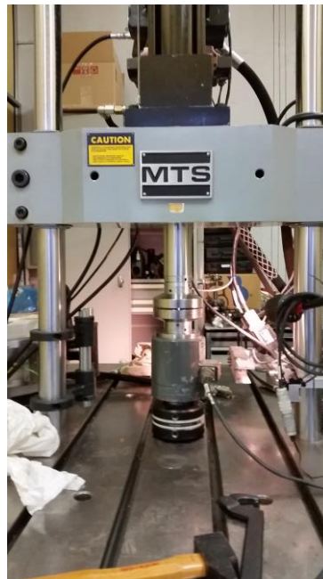
Figura 2.17. Máquina hidráulica MTS, con una celda de carga de 100 kN.
