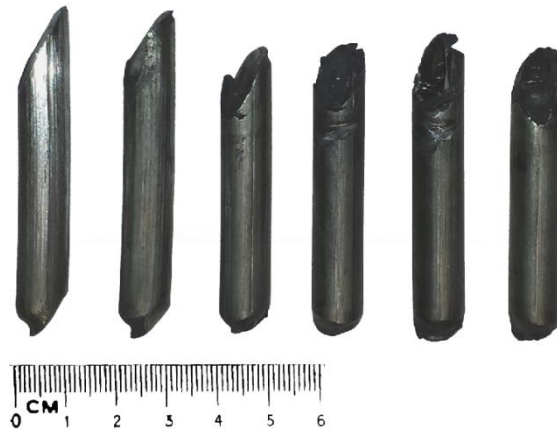
Figura 3.1. Probetas sometidas a SPD. De izquierda a derecha 1, 2, 3, 4, 5 y 6 pasadas.
