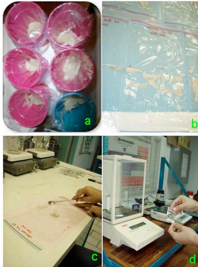
Figura 17. a y b) Procesamiento y extracción y empaquetado de sedimento in situ , c y d) secado, pesado y empaquetado de los sedimentos en laboratorio.
