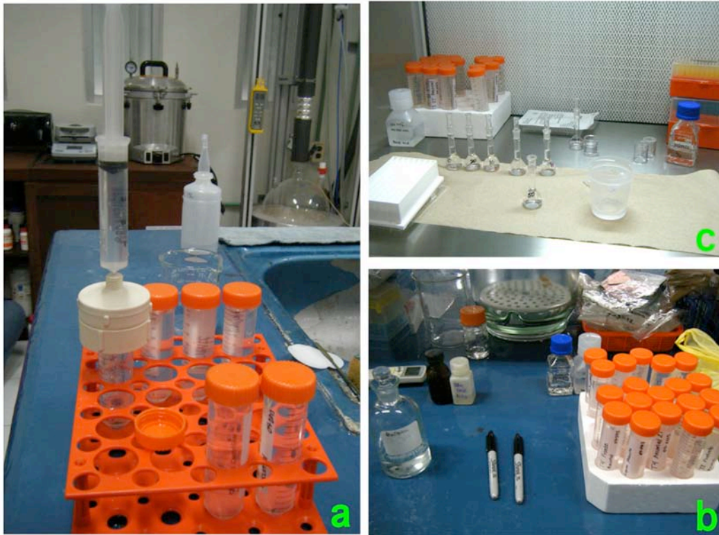
Figura 16. a) Procesamiento de las muestras de agua en laboratorio, b) Filtrado de las muestras, preparación de reactivos y c) curva de calibración para análisis de N y F.
