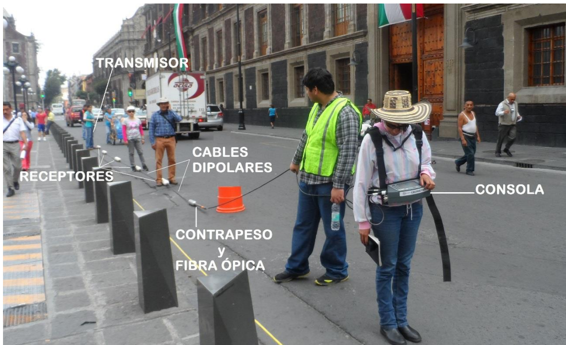
Figura 3A Configuración final del OhmMapper.
