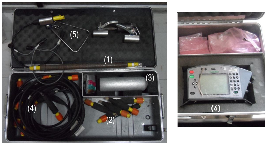
Figura 1A. 1) Acoplador óptico, 2) cierra circuito, 3) contrapeso, 4) cables dipolares, 5) gancho y 6) consola.
