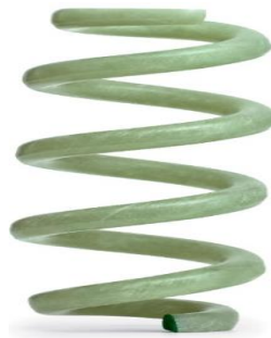
Imagen [14]: Resortes desarrollados por Audi hechos de polímero reforzado con fibra de vidrio (PRFV). ( http://www.todoautos.com.pe/portal/images/stories/audi/Audi-resortes.jpg )
