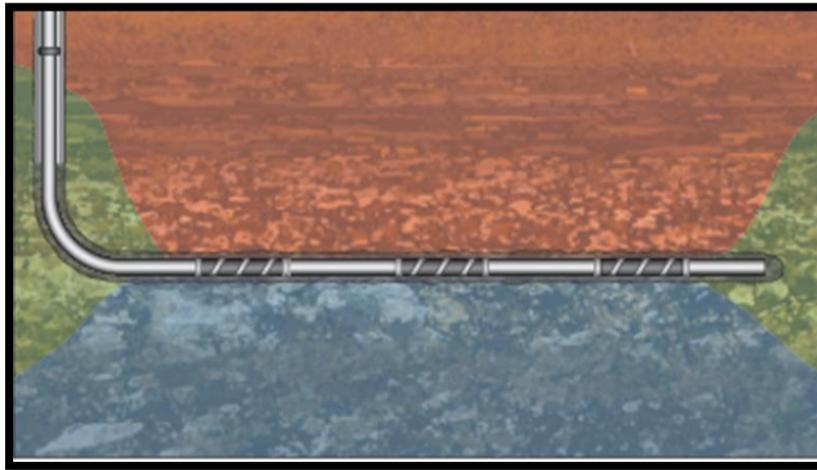
*Figura 88. Pozo horizontal productor de aceite con ICD. [14]*
