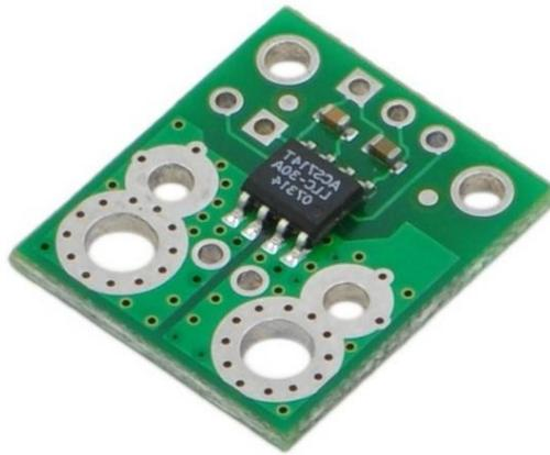
Figura [4.17]. Sensor de corriente ACS714.
