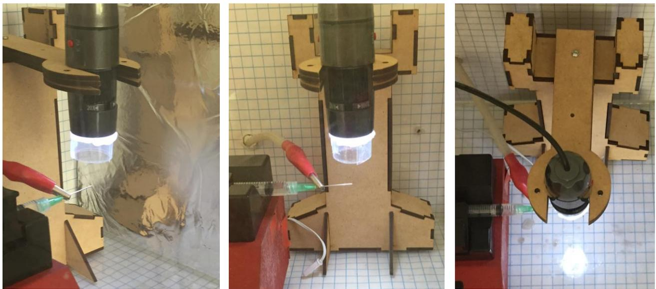
*Figura [3.11]. Prototipo final del soporte para el microscopio dentro de la cabina para electrohilar.*
