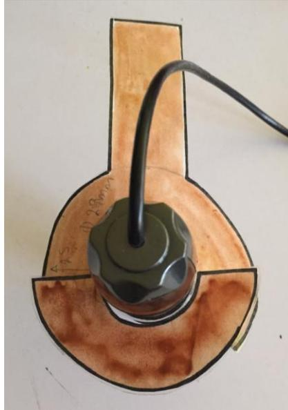
*Figura [2.9]. Modelo funcional del soporte del microscopio con el microscopio (Vista superior).*
