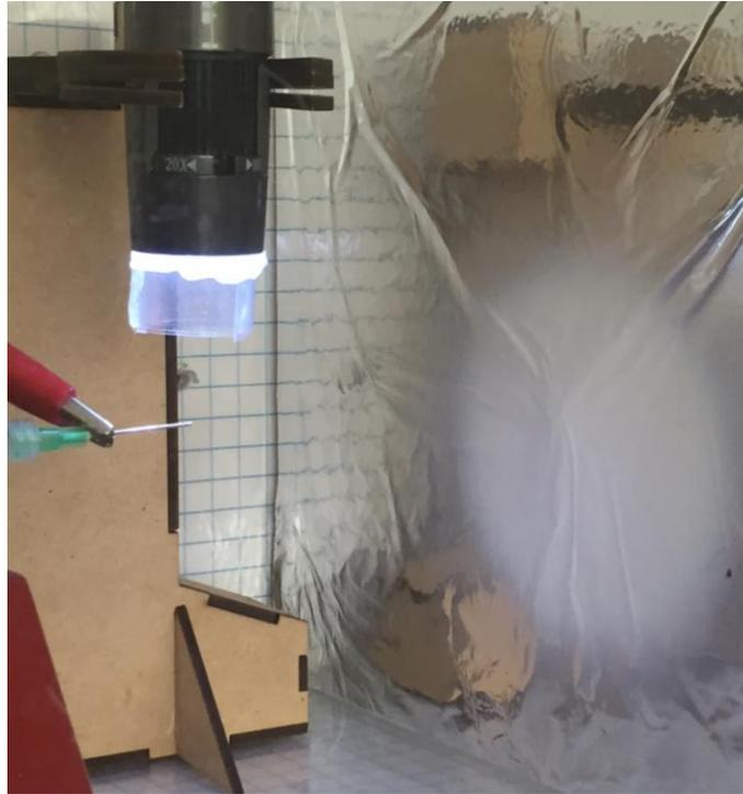
Figura [6.19]. Andamio de fibras durante el proceso de electrohilado.
