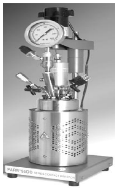
Figura 3.2 Reactor a alta presión utilizado en pruebas de actividad catalítica.
