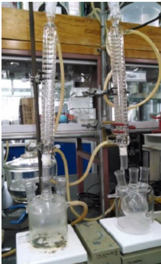
Figura 3.1 Reactor por lotes a presión atmosférica utilizado en pruebas de actividad catalítica.
