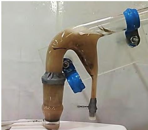
**Figura 3.13 Flotación de ZnS en presencia de Cu<sup>2+</sup> realizada como blanco.**
