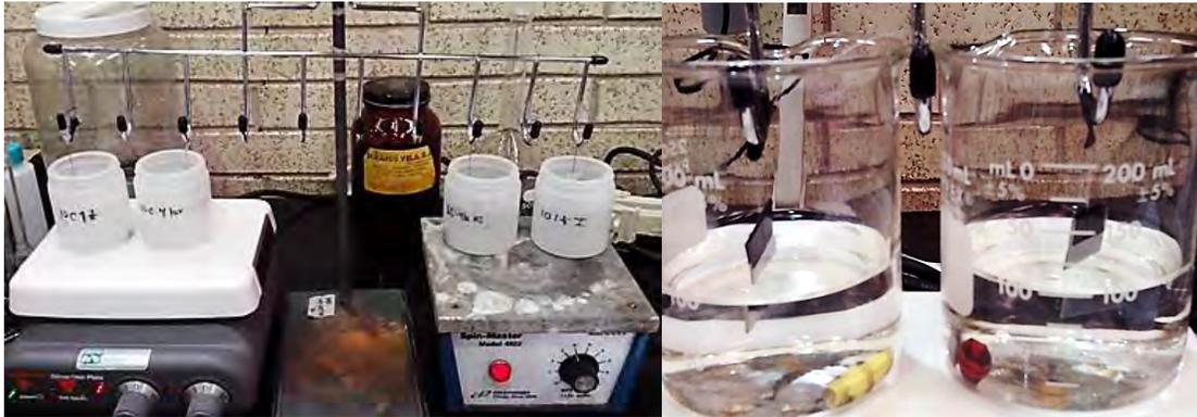
**Figura 3.2 Arreglo empleado en la reducción de  $\text{Cu}^{2+}$  por inmersión a 0.5, 1, 1.5 y 4 horas.**
