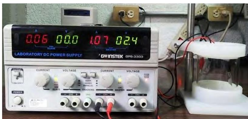
Figura 3.7 Sistema de electrodeposición de Cobre.
