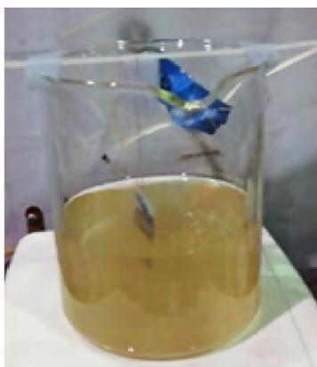
**Figura 3.11 Tratamiento del agua de proceso de flotación del circuito de Zn para la captación de  $\text{Cu}^{2+}$  a pH de 7.5, tiempo de 1 hora y electrodo de acero inoxidable.**
