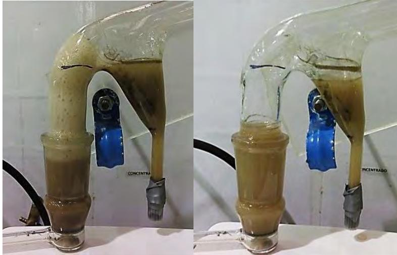
**Figura 3.15 Flotación del ZnS después del tratamiento por EO.**
