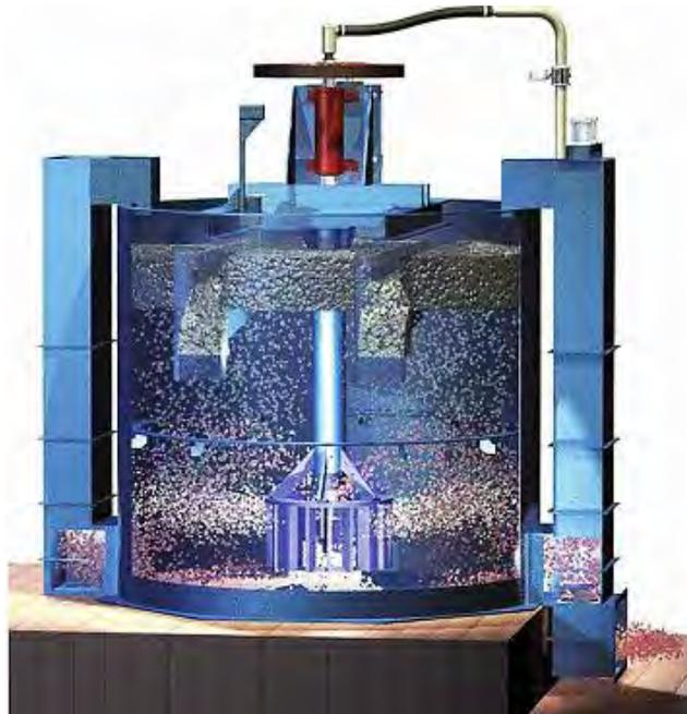
Figura 2.1 Celda de Flotación Mecánica. [19]
