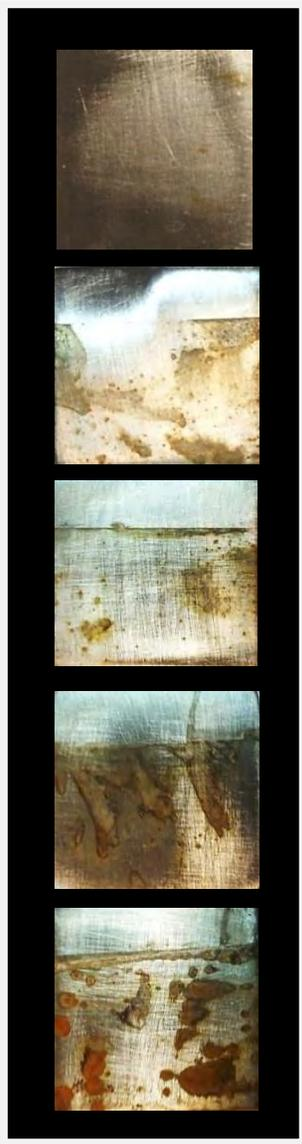
Figura 4.1 Placa de acero al carbón después de 0.5 horas de inmersión en 10 ppm de  $\text{Cu}^{2+}$ .
