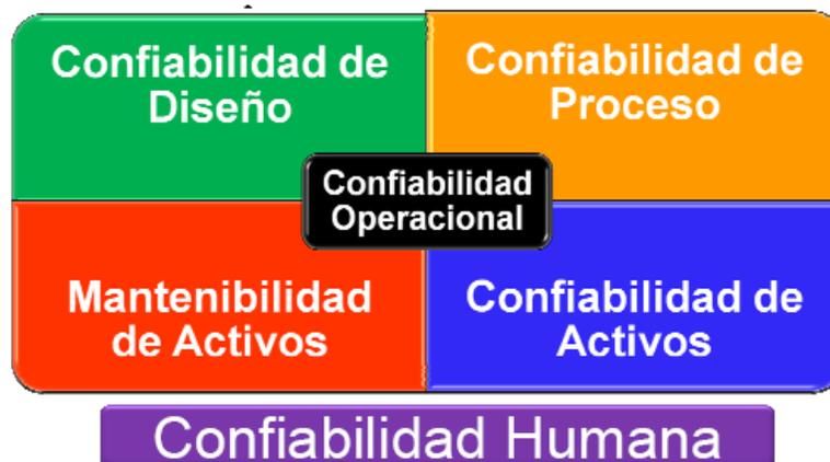
**Figura 1.3.** Componentes de la Confiabilidad Operacional, notando que la Confiabilidad Humana es el soporte de toda su estructura.
