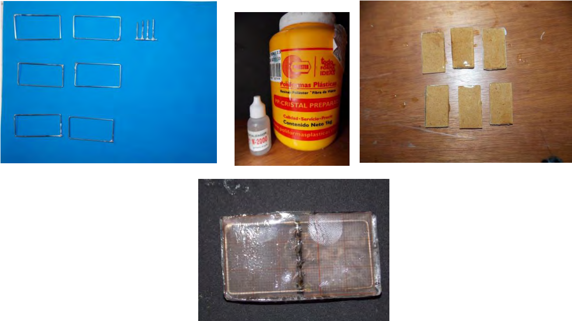
Imagen 17. Materiales empleados para la fabricación de la regla: resina y alambre .
