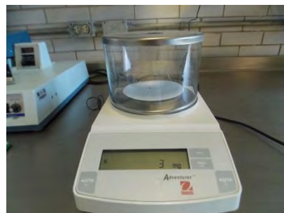
Imagen 11. Medición de la masa del elastómero.
