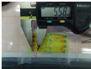
Imagen 14. Medicion de longitudes en regla fabricada con acrilico de ortodoncia.
