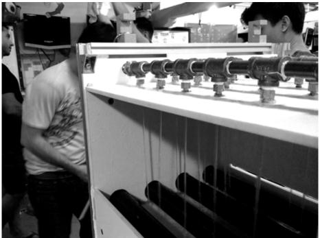
**F. 78**Sistema de riego del refrigerante utilizado en el Polar Roller versión final.
