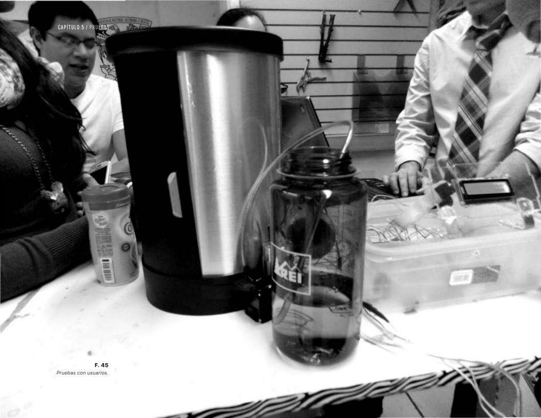
Una vez que encendíamos el lce Lucho, los LEDs empezaban a prender y apagar repetitivamente, el motor vibrador se encendía, la bomba de agua empezaba a funcionar y el agua azul a burbujear para aparentar que el prototipo necesitaba de cada una de estas partes para poder enfriar una bebida.
