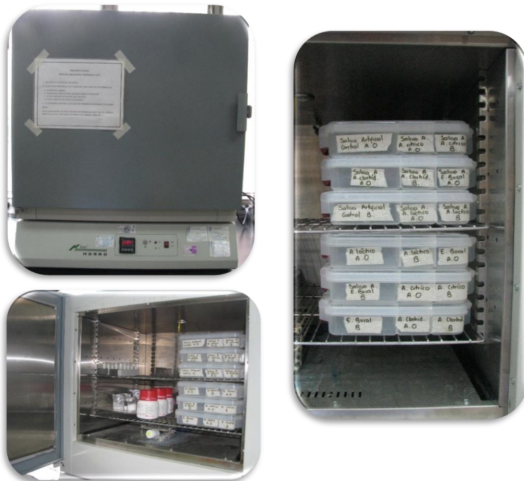
Figura 5. Distribución de los alambres dentro de la cabina de temperatura controlada.
