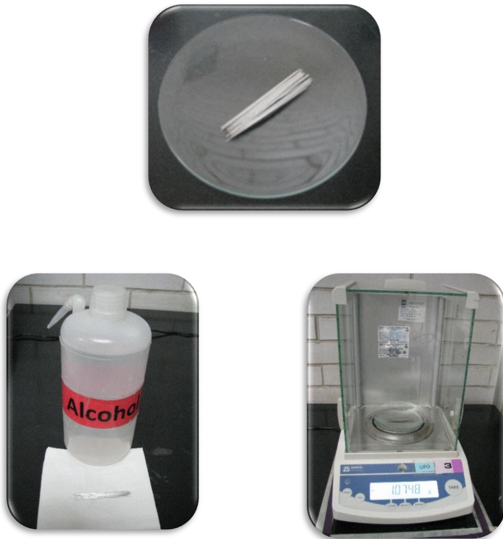
Figura 9. Preparación y medición de las secciones para determinar su masa.
