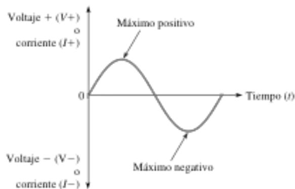
FIGURA 2.3 FORMA IDEAL DE UNA ONDA SENOIDAL DE TENSIÓN. (Torres, 2010)
