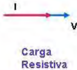
FIGURA 2.4 REPRESENTACIÓN VECTORIAL DE LAS MAGNITUDES DE CORRIENTE Y TENSIÓN EN FASE 4 .
