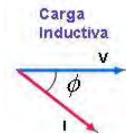
FIGURA 2.6 REPRESENTACIÓN VECTORIAL DE LAS MAGNITUDES DE CORRIENTE Y TENSIÓN DE UNA CARGA INDUCTIVA 5
