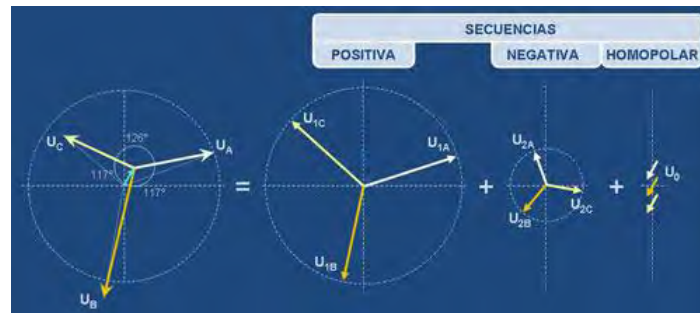
FIGURA 3.4 REPRESENTACIÓN DE SECUENCIAS POSITIVA, NEGATIVA Y HOMOPOLAR O CERO.
