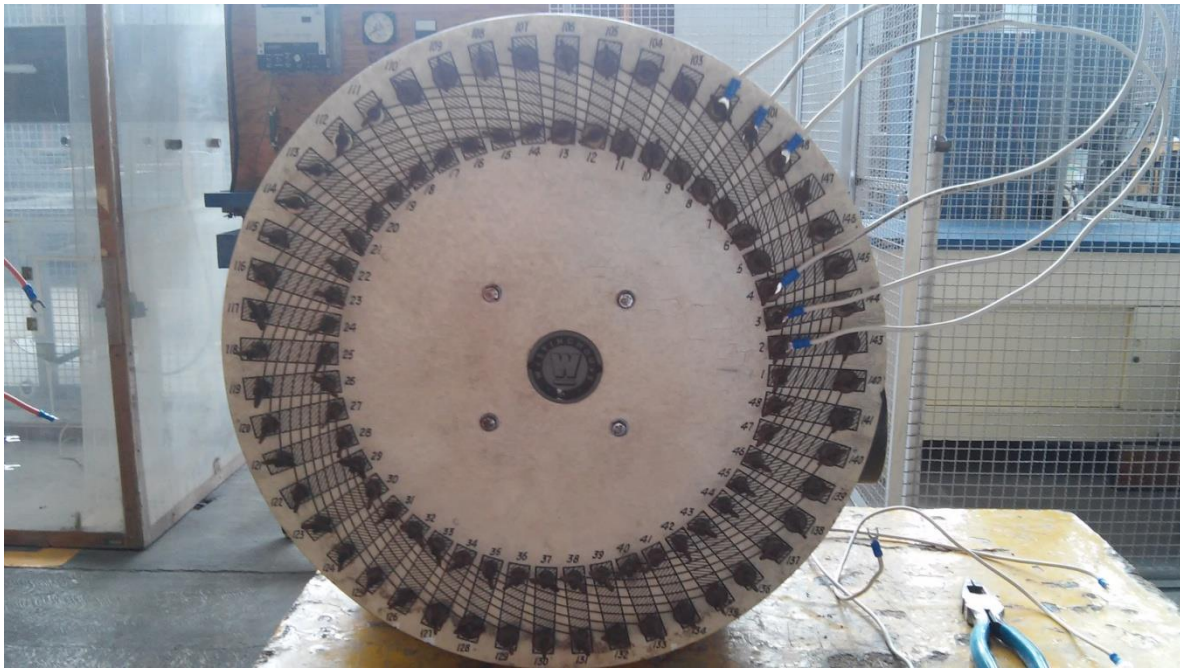
Figura 29: Vista del tablero de conexiones de sus bobinados
