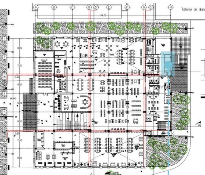
Localización en planta de cuarto para instalaciones de aire acondicionado, con acceso desde fuera del edificio.
