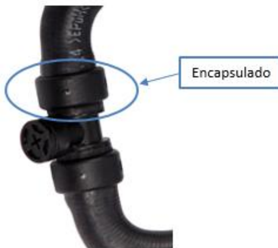
FIGURA 4.7 Encapsulado en mangueras (Cooper standard, 2016)
