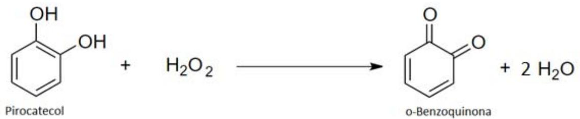
*Figura 8. Reacción de oxidación del pirocatecol con peróxido de hidrógeno.*
