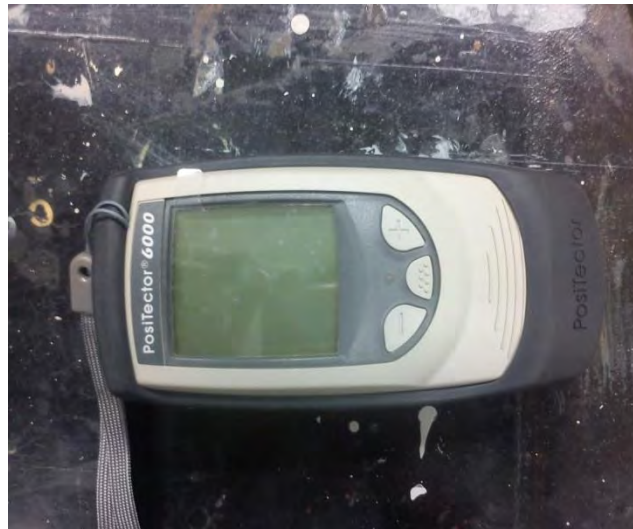
Figura 102. Medidor digital para medir recubrimientos sobre superficies ferrosas (F) y no-ferrosa POSITECTOR 6000.
