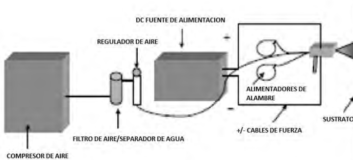
Figura 15. Sistema de pulverización de arco de dos hilos Típica.
