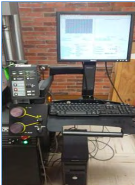
Figura 26. Ejecución del software Partner para La obtención de datos del ensayo de tracción.
