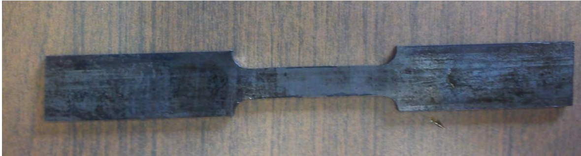
Figura 91. Forma de las probetas según la norma ASTM E8.
