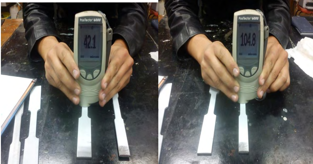
Figura 103. Medición de espesores con POSITECTOR 6000.
