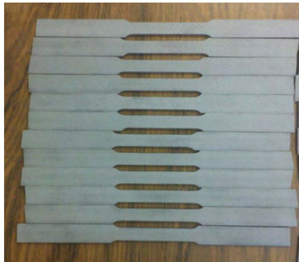
Figura 97. Probetas 1010 sand blasteadas.
