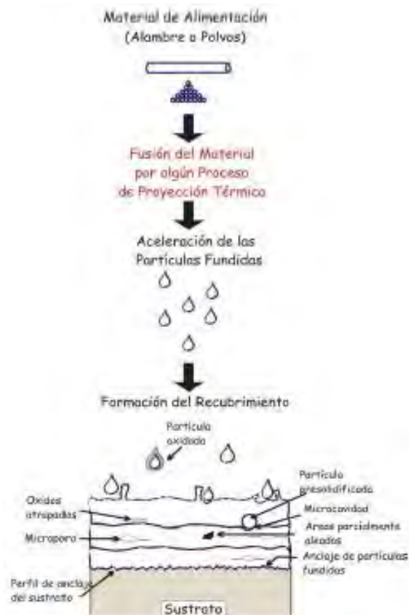
Figura 8. Proceso de deformación de un recubrimiento.
