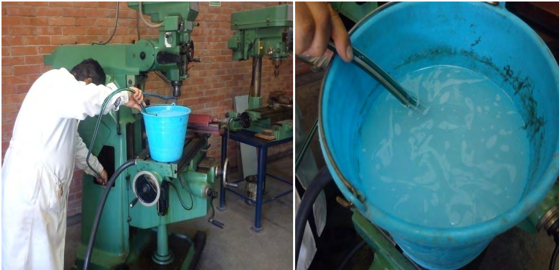
Figura 85. Administración de refrigerante a la fresadora universal.
