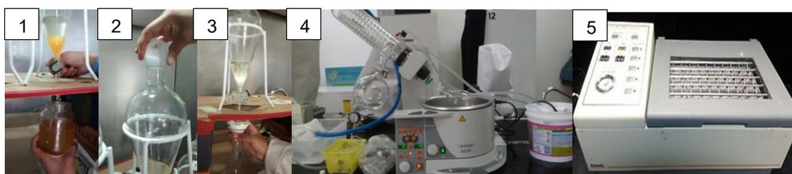
Figura 39. Procedimiento para la extracción de la Patulina: 1) Extracción de la fase inferior en el embudo de separación, 2) Adición del sulfato de sodio a la fase superior recuperada, 3) Decantación de la muestra por un filtro de microfibras, 4) Evaporación en rotavapor al vacío, 5) Evaporación final con corriente de nitrógeno.
