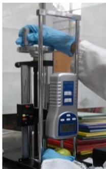
Figura 37. Determinación de la firmeza de los frutos por un penetrómetro digital.
