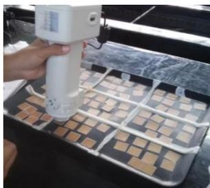
Figura 29. Determinación de color en películas modelo por el colorímetro.
