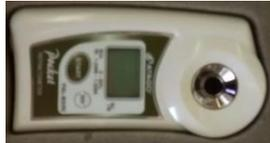
Figura 33. Refractómetro digital para la determinación de sólidos solubles de los frutos.
