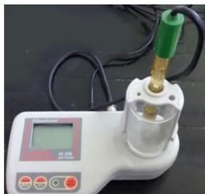
Figura 35. Potenciómetro para la determinación del pH de los frutos.
