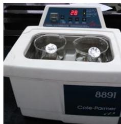
Figura 23. Baño de ultrasonido empleado para la obtención de extractos etanólicos.
