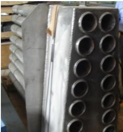
Ilustración 20.- Internos tipo ciclónicos. [4]
