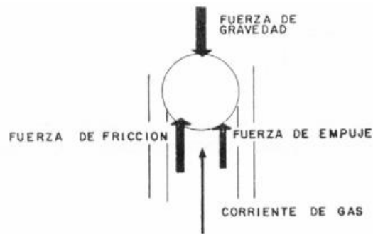
Ilustración 13.- Fuerzas que actúan sobre una gota de líquido que cae contra una corriente de gas. [1]
