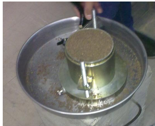
Figura A.13. Limpieza exterior del molde
