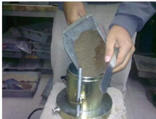
Figura A.11 Formación de la probeta
