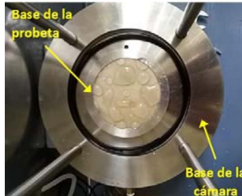
Figura A.21 Saturación de línea inferior.
