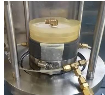
Figura A.25 Colocación del cabezal.
