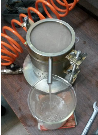
Figura A.17 Saturación de la probeta de arena gris
