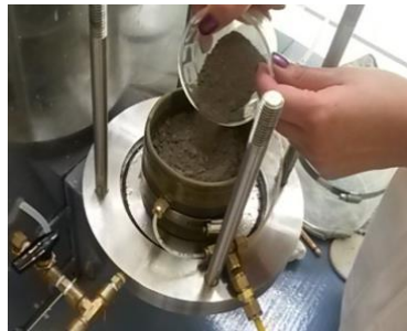
Figura A.24 Formación de la probeta.
