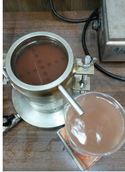
Figura A.18 Saturación de la probeta de arena rojiza
