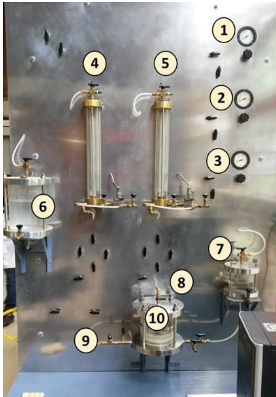
Figura A.19 Elementos del permeámetro pared flexible del Instituto de Ingeniería de la UNAM.
