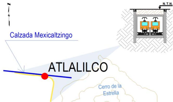
Figura 3.11 Sección en cajón somero.
