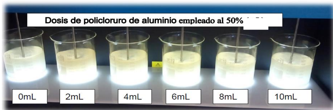
Figura 20. Muestra M010 al 30% más dosis de 0 a 10mL de policloruro de aluminio al 50%.
