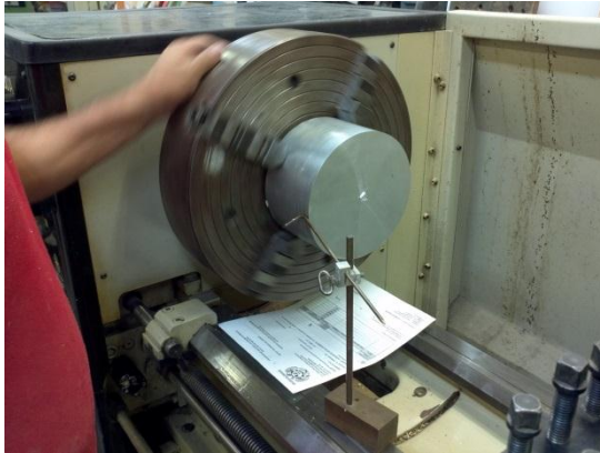
Ilustración 22.-Centrado del material. Hernández Orozco 2016.
