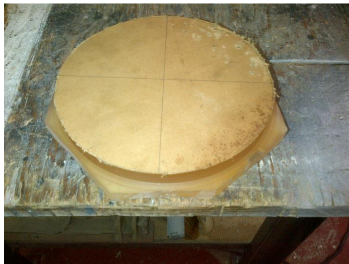
Ilustración 30.- Primer paso de desbaste en las placas de PMM. Hernández Orozco 2016.
