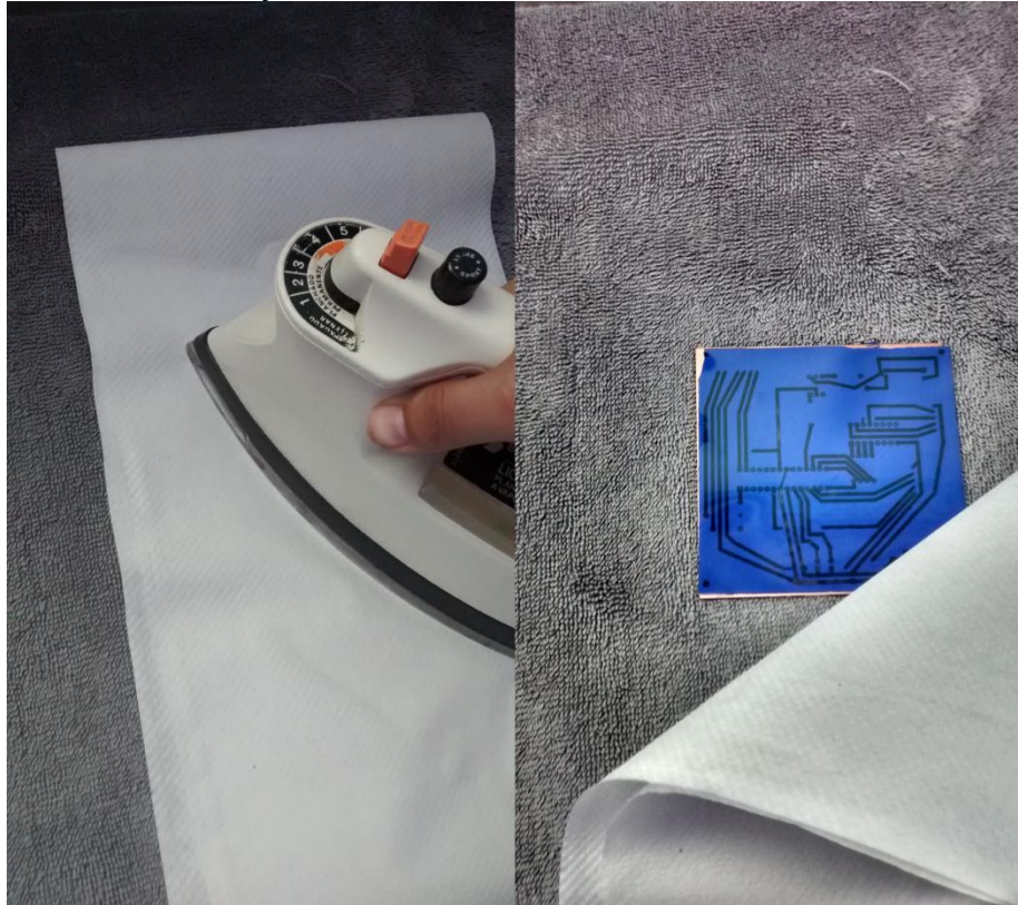
Ilustración 51.- Detalle de la transferencia de la hoja azul a la placa fenólica. Hernández Orozco 2016.
