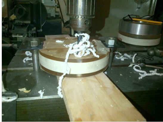
Ilustraci3n 31.- Barrenado de las Bridas. Hern ndez Orozco 2016.
