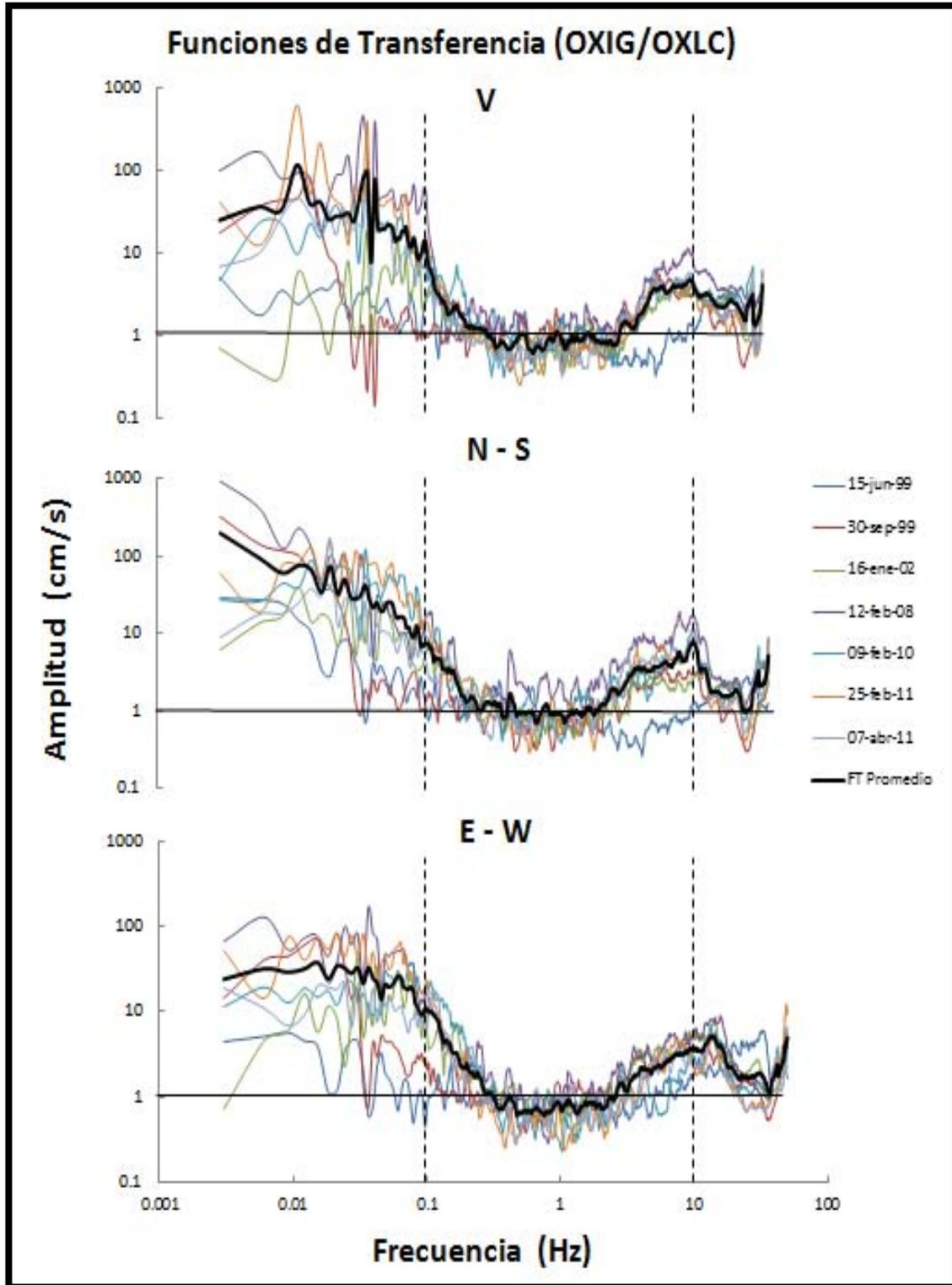
Fig. 52 Funciones de Transferencia de los 7 sismos analizados.
