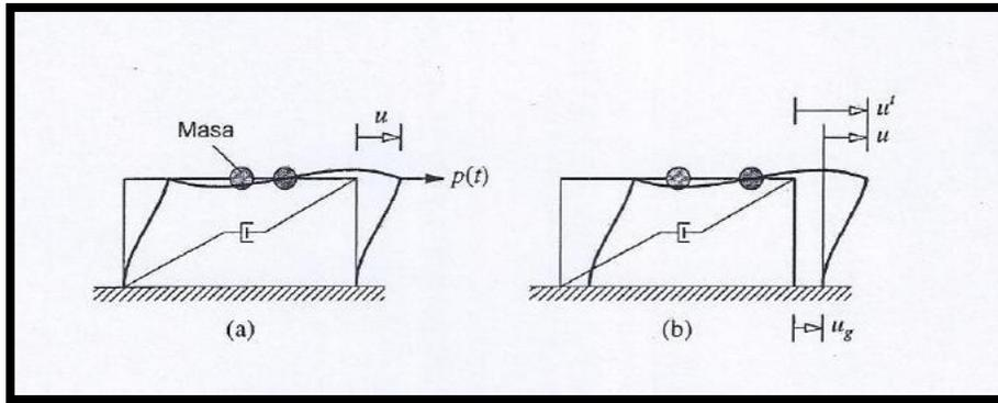
Fig. 11 Sistema de Un Grado de Libertad
