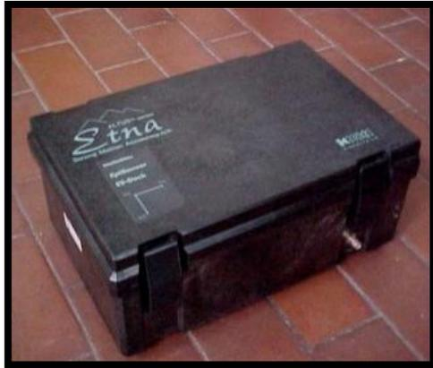
Fig. 22 Acelerógrafo ETNA/1328.
