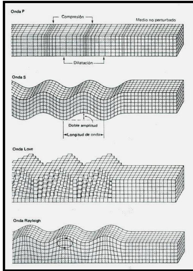
Fig. 7 Tipos de Ondas Sísmicas (Ref 13).
