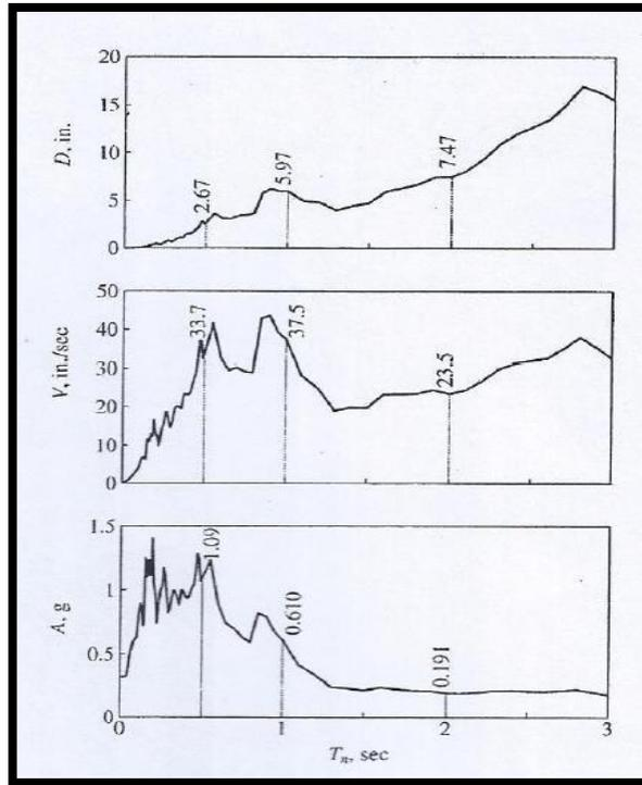
Fig. 13 Espectro de Respuesta de Desplazamiento (D)
