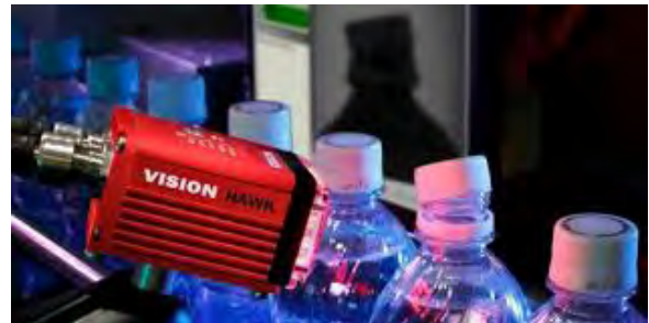
Figura 2.8. Inspección por visión artificial de botellas
