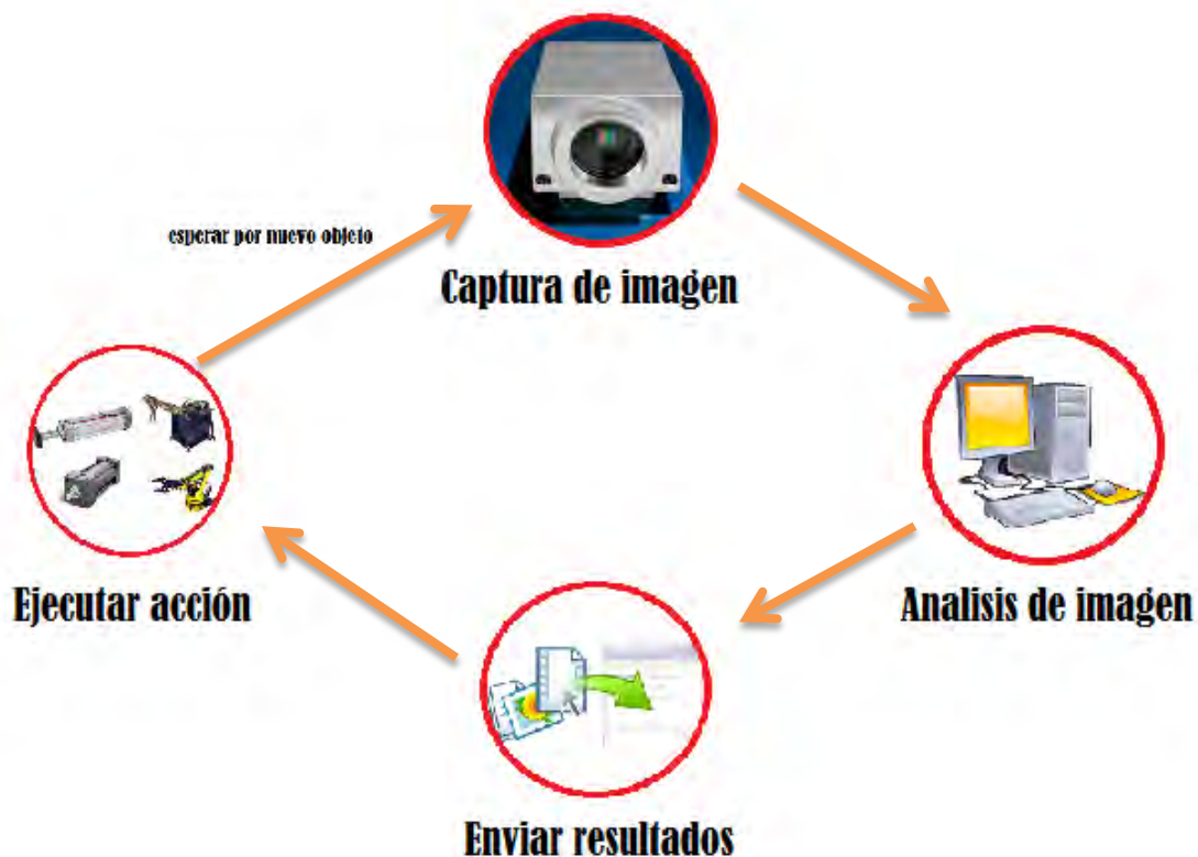
Figura 2.9. Ciclo básico de la visión artificial usada en industria (imagen Propia basada en: Visión artificial una tecnología industrial)
