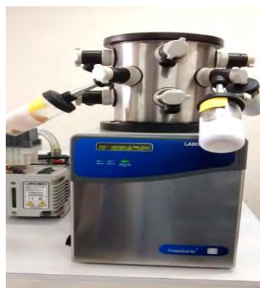
Fig. 19 Uso de la Liofilizadora, resecaando nuestras muestras.
