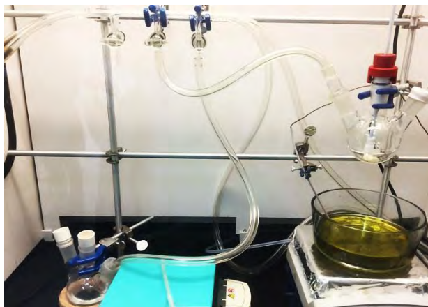
Fig. 15 Sistema desarrollado para la obtención de nanopartículas magnéticas.
