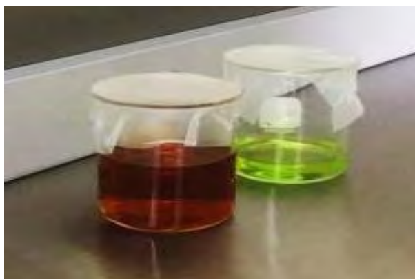
Fig.16 Soluciones obtenidas de Cloruro de Hierro (III) en color cafe y Cloruro de hierro(II) en color verde.
