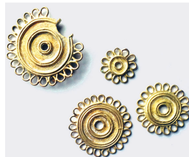
Imagen 133. Piezas vaciadas a la cera perdida en liga de oro.
