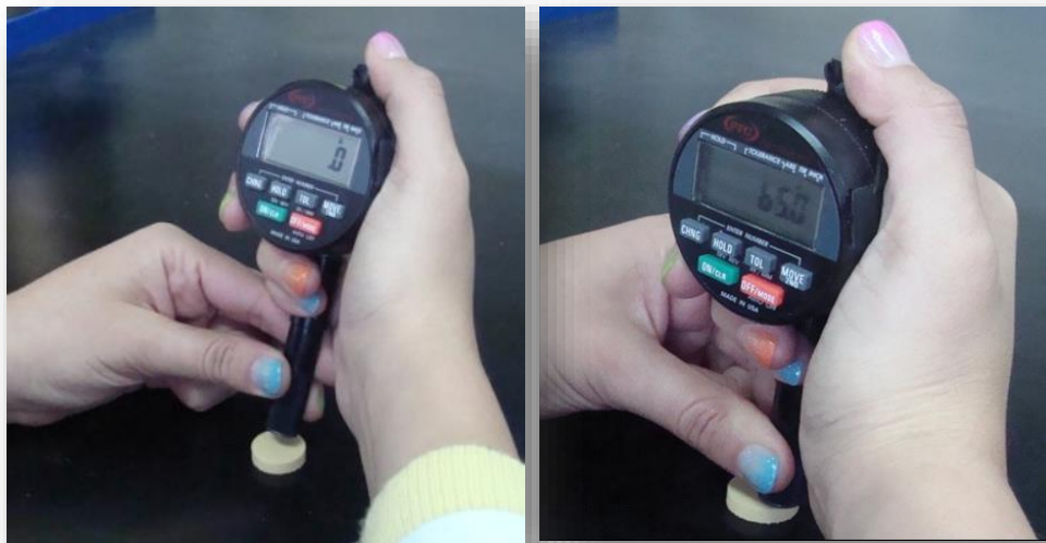
Figura 13. Medición de la dureza. La dureza de las tabletas debe encontrarse en el rango de 62 a 65 unidades shore A.
