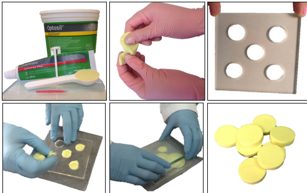
Figura 11. Fabricación del alimento prueba artificial. A) Silicona y activador B) Mezclado del material C) Plantilla de acrílico perforada D) Colocación del materia en la plantilla E) Prensado manual F) Tablet as polimerizadas.
