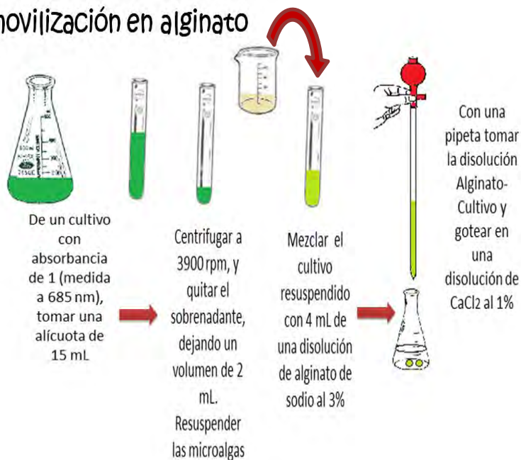
Figura 2.5 Procedimiento seguido para inmovilizar las microalgas.
