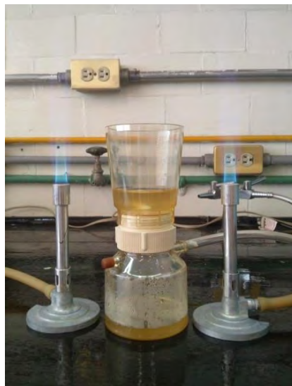
Figura 2.4 Esterilización del alginato de sodio, a través de un sistema de filtración (Imagen propia).
