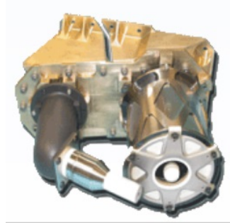
Figura 6.5: Fotografía del propulsor Hall BHT-200 de la compañía Busek Co. acoplado al cátodo BHC-1500 de la misma compañía [9].
