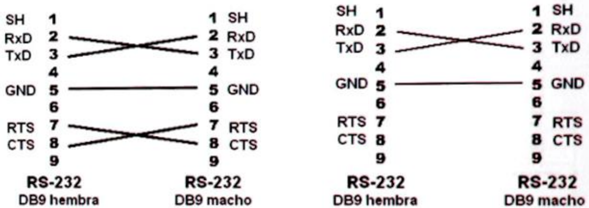
Figura 2.5 Conexiones RS-232 de 5 hilos y de 3 hilos
