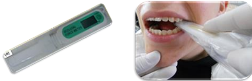
Figura 6. Sensor para MFO y medición de MFO. Fuente directa
