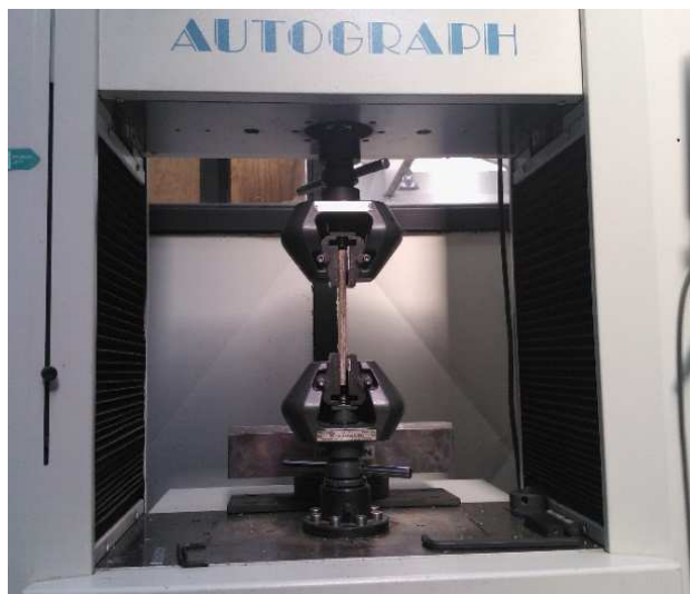
Ilustración 19. Ensayo a tensión de probetas de resina epoxica con refuerzo de fibras de henequén
