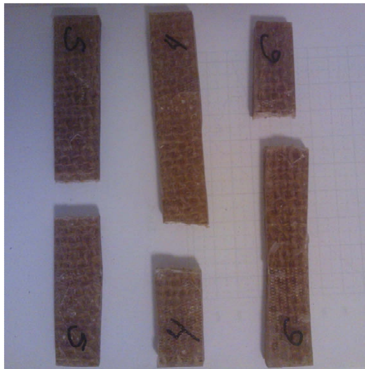
Ilustración 21. Probetas del lote 2 después de ser ensayadas a tensión
