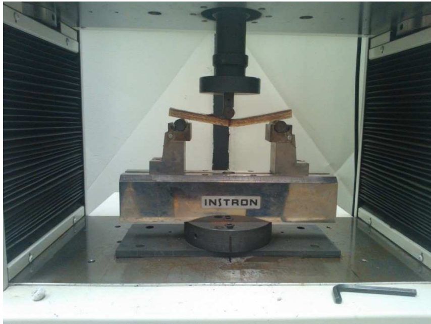
Ilustración 18 ensayo a flexión de probetas de resina epoxica con refuerzo de fibras de henequén
