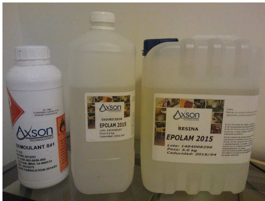
Ilustración 12. Resina epoxica Epolam 2105, endurecedor Epolam 2015 y desmoldante 841, todos marca Axson
