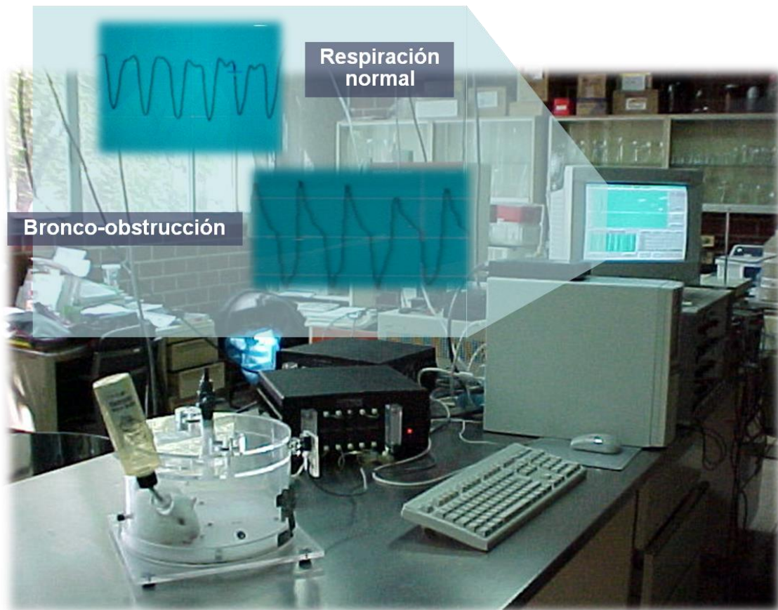
Figura 8. Equipo de pletismografía barométrica. Con éste equipo es posible medir la función pulmonar de los cobayos y observar su respuesta bronco-obstruccion. Modificada de Chavez-Alderete J., 2007. Tesis Doctoral Efecto paradójico del salbutamol sobre las vías aéreas en un modelo de intoxicación aguda por organofosforados en cobayos. UNAM, México D. F.
