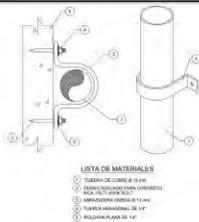
SOPORTE TIPO OMEGA EN MURO
