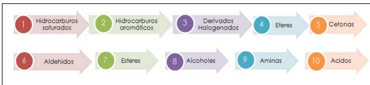
Figura 4. 2: Orden de elución de los compuestos en el cromatógrafo.
