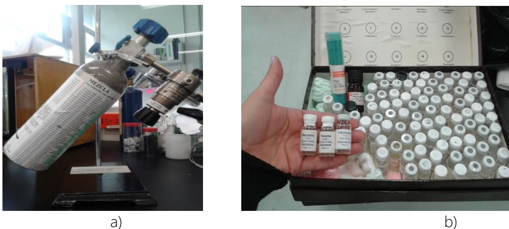
Figura 5. 10: Calibración con estándares: a)Estándar gaseoso marca Spectra, b) KIT de estándares líquidos PolyScience.
