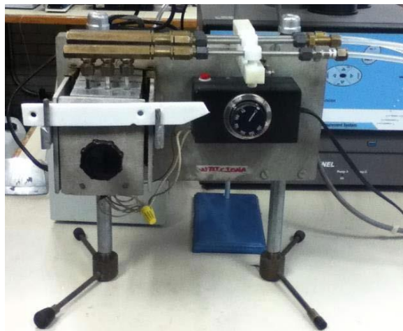
Figura 5. 5: Equipo de acondicionamiento de cartuchos absorbedores.
