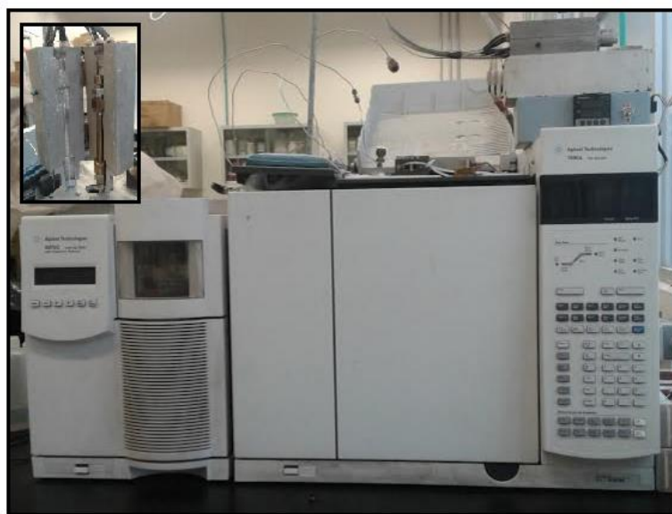
Figura 5. 8: Cromatógrafo Agilent modelo 7890AGC. Recuadro interior termodesorción de la muestra.
