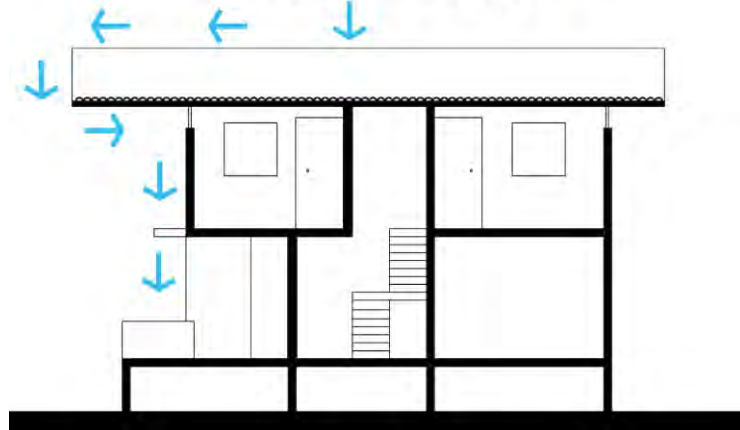
[Sistema de captación pluvial]
