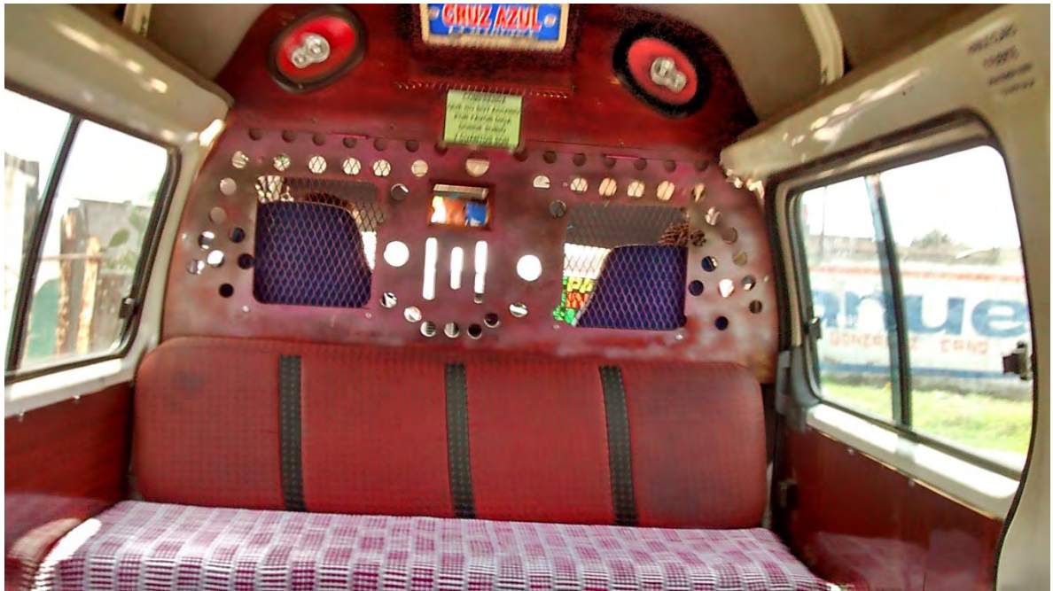
Foto: Víctor Hugo Cortés 2013. Combi con protección por la que se observa una rendija para pasar el pago y dar el cambio al pasajero, que es decorada del mismo color que el resto del interior en un tono rojizo.
