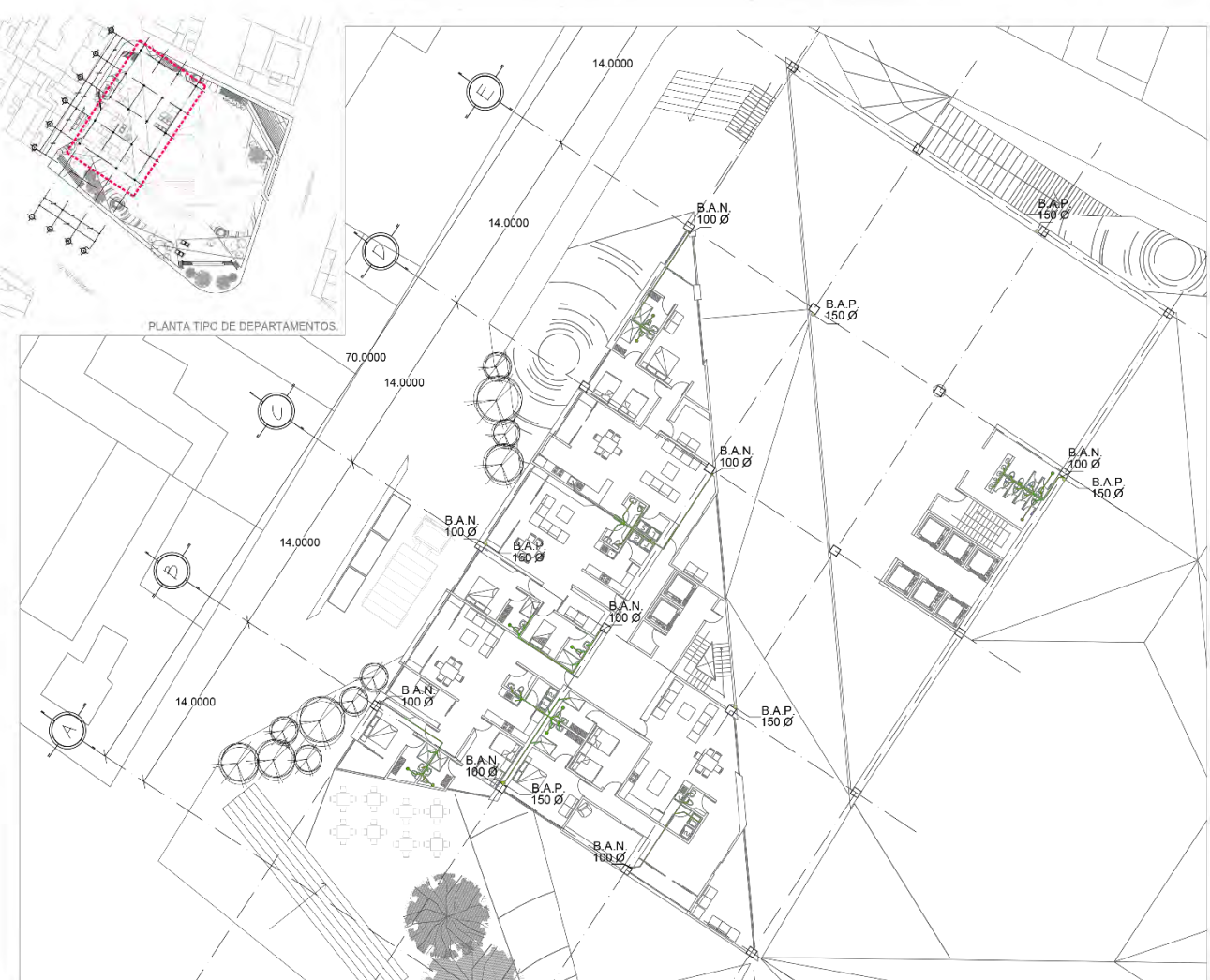
INST. SANITARIA PLANTA TIPO DEPTOS/OFCINAS.
