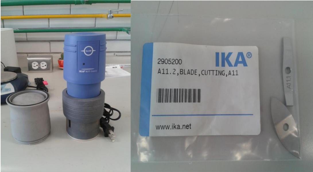
Figura 5. Molino IKA serie A11 Basic junto con sus elementos molientes de impacto y cizalla.
