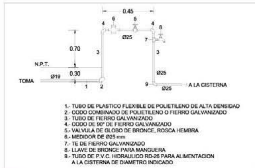
DETALLE DE CUADRO DE MEDIDOR
