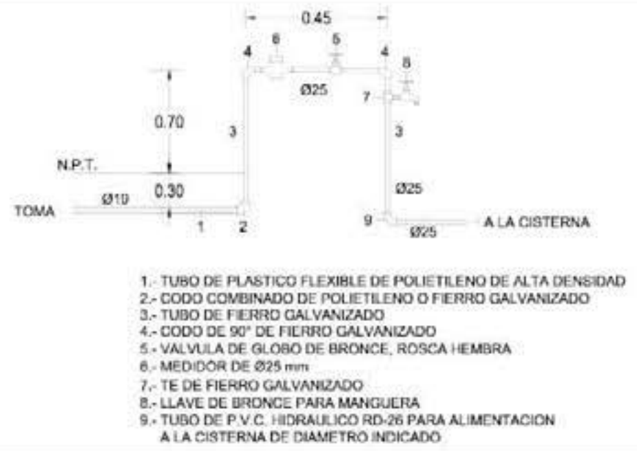
DETALLE DE CUADRO DE MEDIDOR
