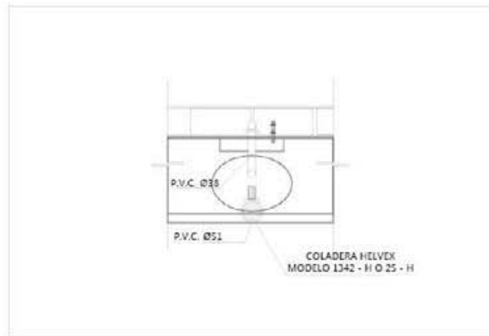
DETALLE DE DRENAJE DE LAVABO, PLANTA
