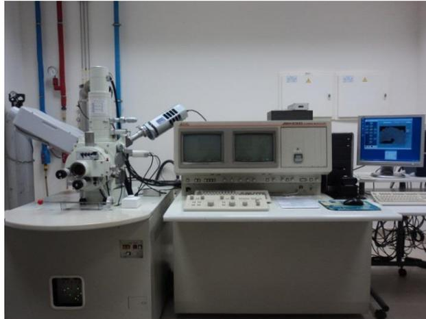
Figura 3.12. SEM JSM-6300 con EBSD. UPV.
