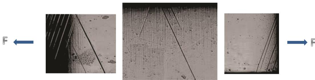
Figura 4.2. VMs formadas en el  $M_1$  sometido a tensión simple, en lado izquierdo, sección central y lado derecho Kaouache [63].
