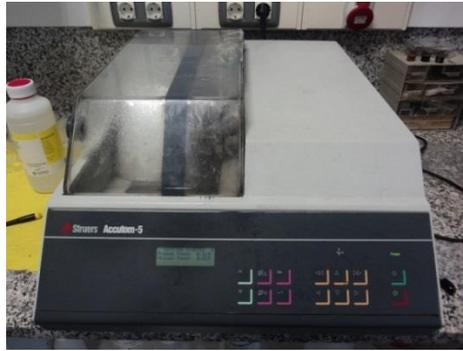
Figura 3.5. Cortadora automática Accutum-5 UPV.
