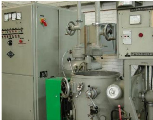
Figura 3.1 Horno de inducción ubicado en el laboratorio de proceso de materiales avanzados del IIM-UNAM
