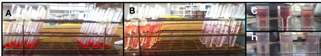
Figura 11. Determinación de antocianinas totales. A) Extracto bruto de frambuesa. B) Extracto con soluciones buffer añadidas. C) Medición pH 1.0. D) Medición pH4.5.
