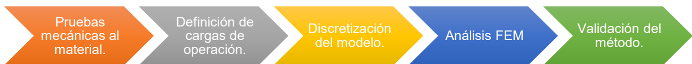
Figura 4.1 Proceso de la validación estructural
