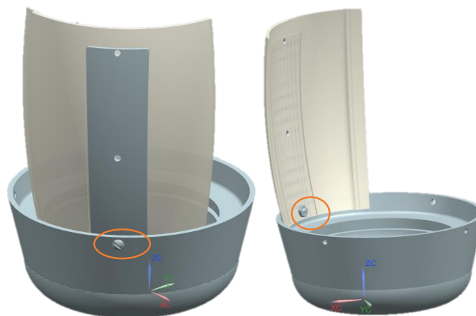
Figura 5.10 Aseguramiento de barras verticales y paredes
