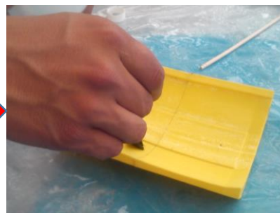
Figura 3.23 Aplicación de película separadora
