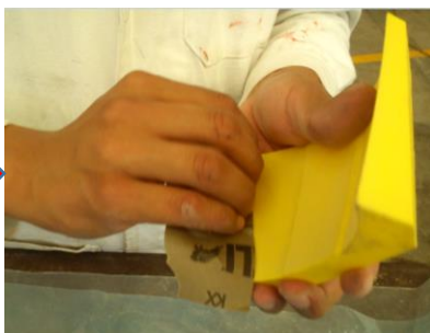
Figura 3.22 Acabado superficial al molde
