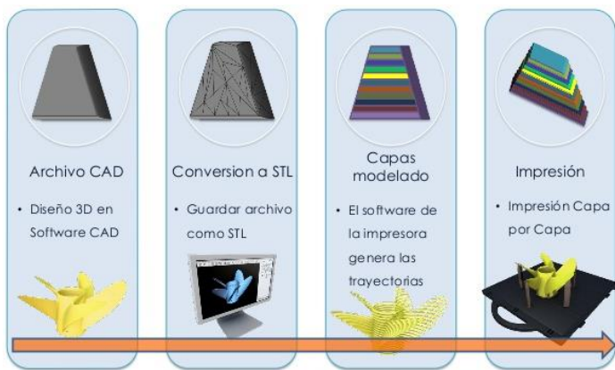
Figura 3.7 Proceso de manufactura aditiva [27]
