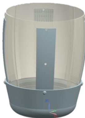
Figura 5.11 Ensamble final de la base con paredes y barras verticales
