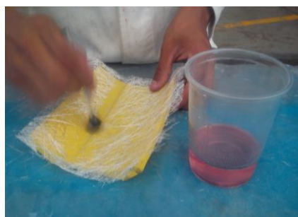
Figura 3.27 Aplicación de Resina y 1ª capa de fibra
