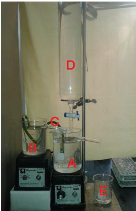
Figura 13. Sistema in vitro para administración oral, A , compartimento central. B , compartimento periférico. C , manguera de la bomba peristáltica, D , columna. E , probeta para recolectar el fluido eliminado
