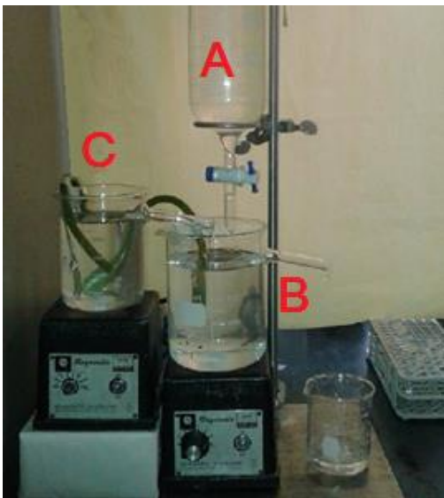
Figura 7. Sistema in vitro . A , columna, permite la entrada de agua al compartimento central. B , compartimento central. C , compartimento periférico.
