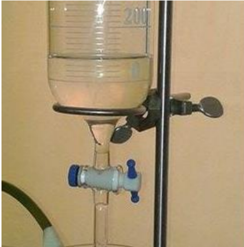
Figura 9. Columna asegurada al soporte universal con una abrazadera.
