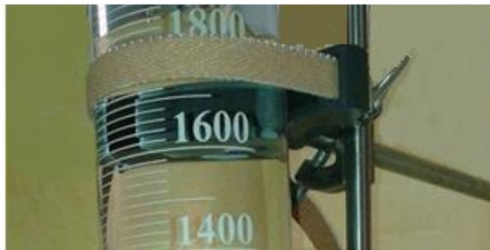
Figura 9. Columna asegurada al soporte universal con una abrazadera.
